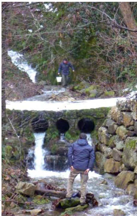
▲ Experimentos de medida de caudal durante una precipitación.
